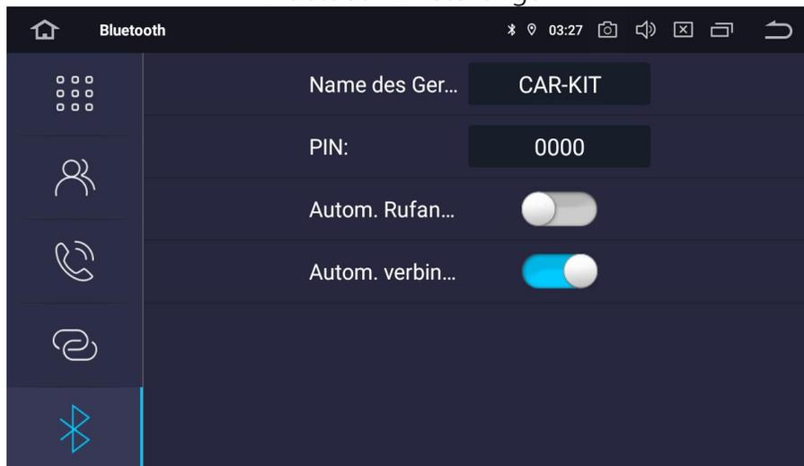
In den Bluetooth-Einstellungen können Sie den Anzeigenamen des AV8V7-Ultra sowie die Bluetooth-PIN ändern. Weiterhin können Sie einstellen, ob das AV8V7-Ultra Verbindungsanfragen automatisch akzeptieren oder ablehnen soll.
