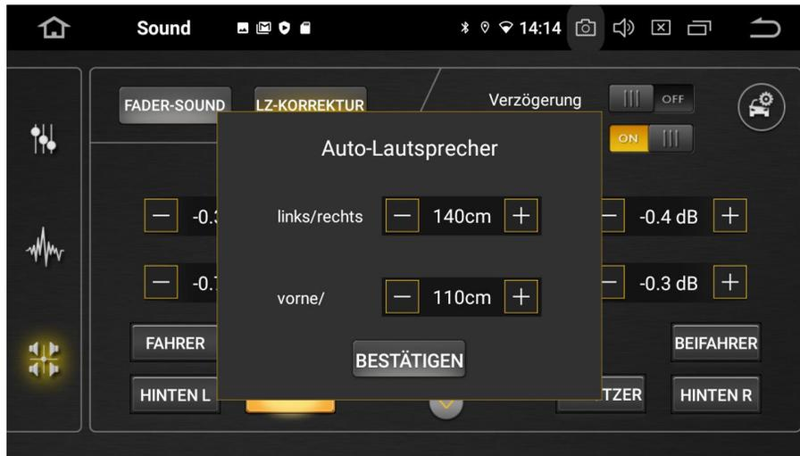
In dem gezeigten Menü lässt sich die Laufzeitverzögerung einstellen. Geben Sie die genauen Abstände der Entfernung zwischen dem linken/rechten und vorderen/hinteren Lautsprecher ein.
