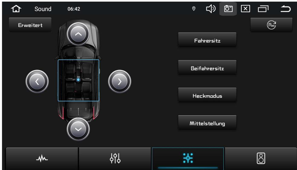
Positionieren Sie den Punkt auf die Position, auf die der Sound ausgerichtet werden soll. Das Gerät rechnet nun selbständig die passende Lautstärke und Laufzeitverzögerung aus.
