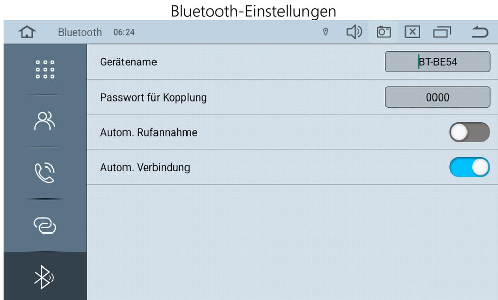
In den Bluetooth-Einstellungen können Sie den Anzeigenamen des AV8V7-L2 sowie die Bluetooth-PIN ändern. Weiterhin können Sie einstellen, ob das AV8V7-L2 Telefonanrufe und Verbindungsanfragen automatisch akzeptieren oder ablehnen soll.
