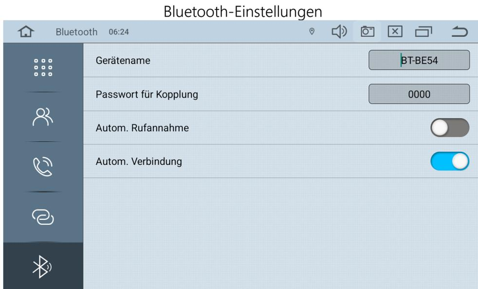
In den Bluetooth-Einstellungen können Sie den Anzeigenamen des AB9-L2 sowie die Bluetooth-PIN ändern. Weiterhin können Sie einstellen, ob das AB9-L2 Telefonanrufe und Verbindungsanfragen automatisch akzeptieren oder ablehnen soll.
