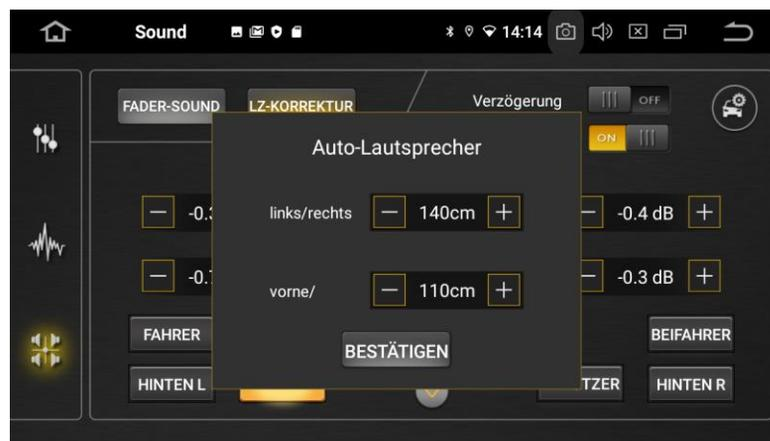
In dem gezeigten Menü lässt sich die Laufzeitverzögerung einstellen. Geben Sie die genauen Abstände ein der Entfernung zwischen dem linken/rechten und vorderen/hinteren Lautsprecher ist.
