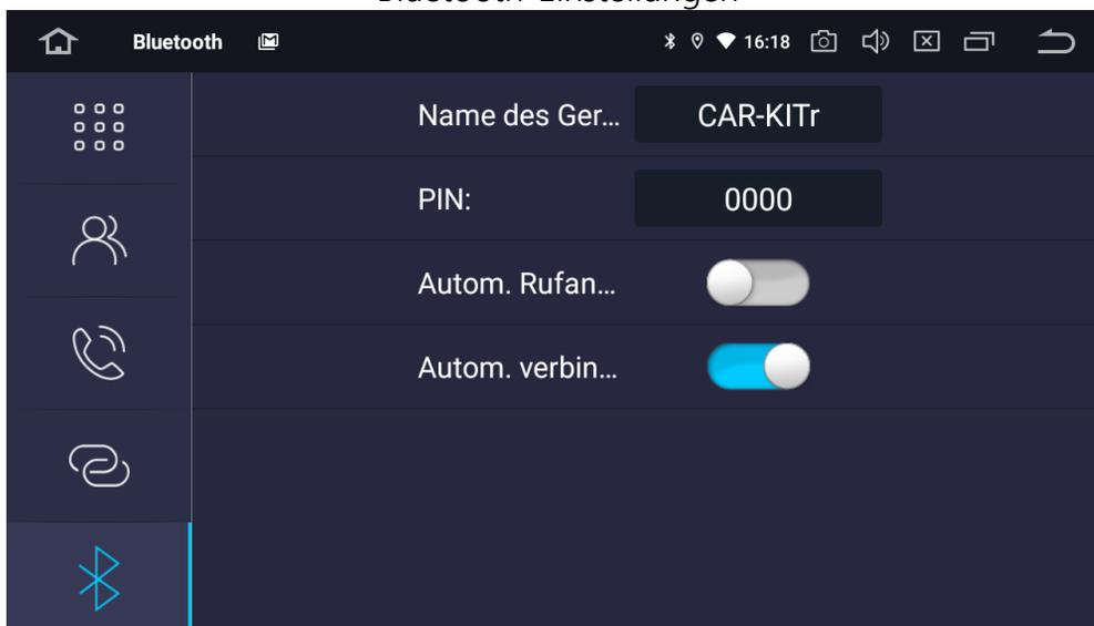
In den Bluetooth-Einstellungen können Sie den Anzeigenamen des AV8V6 sowie die Bluetooth-PIN ändern. Weiterhin können Sie einstellen, ob das AV8V6 Verbindungsanfragen automatisch akzeptieren oder ablehnen soll.
