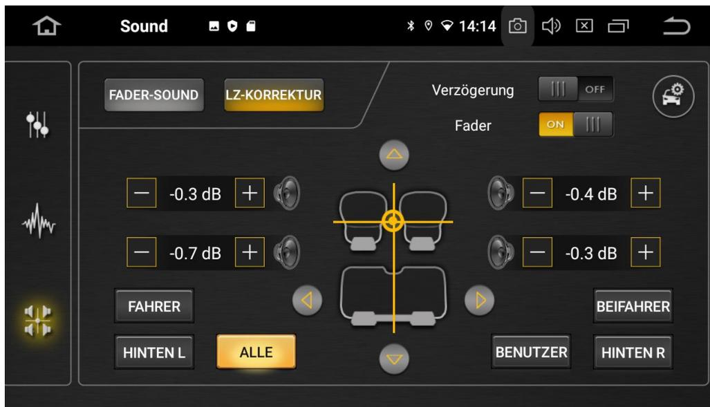
Positionieren Sie anschließend das Fadenkreuz auf die Position, auf die der Sound ausgerichtet werden soll. Das Gerät rechnet nun selbständig die passende Laufzeitverzögerung aus. Weiterhin können Sie in dem Menü für alle Lautsprecher einzeln eine Lautstärkeanpassung einstellen.
